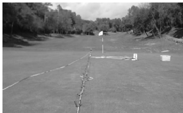
Fig. 1. Disposición de los electrodos sobre uno de los *green*
