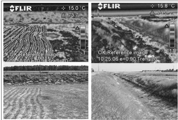
Fig 7. a) a d). Comparación entre los aspectos de una fotografía normal y una termografía, con objeto de detectar procesos colmatantes.
