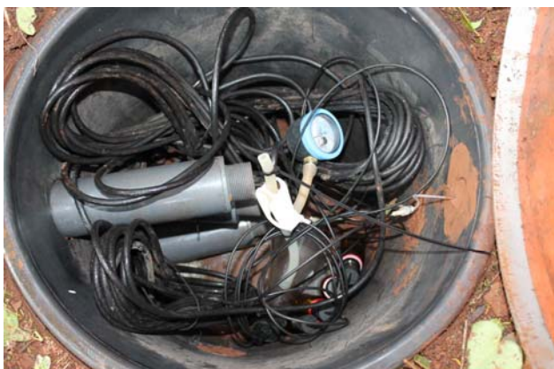
Fig. 3. Zanja de estudio donde se muestran las sondas TDR y extractores Rhizon insertados en el perfil de suelo
